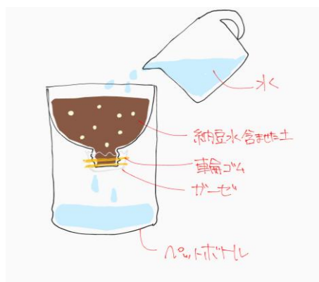
図1 保水力を確かめるための装置
