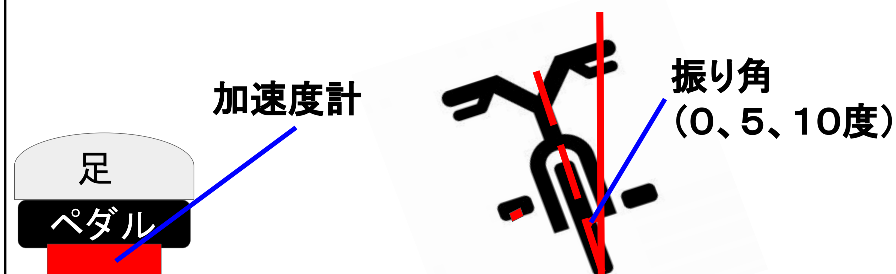
図1 ペダル拡大図
