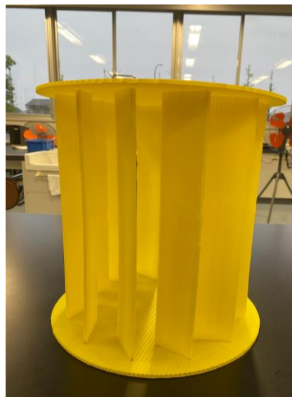
図2 製作したクロスフロー型風力発電機の羽部分(12枚羽)
