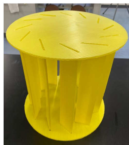
図2 製作したクロスフロー型風力発電機の羽部分(12枚羽)
