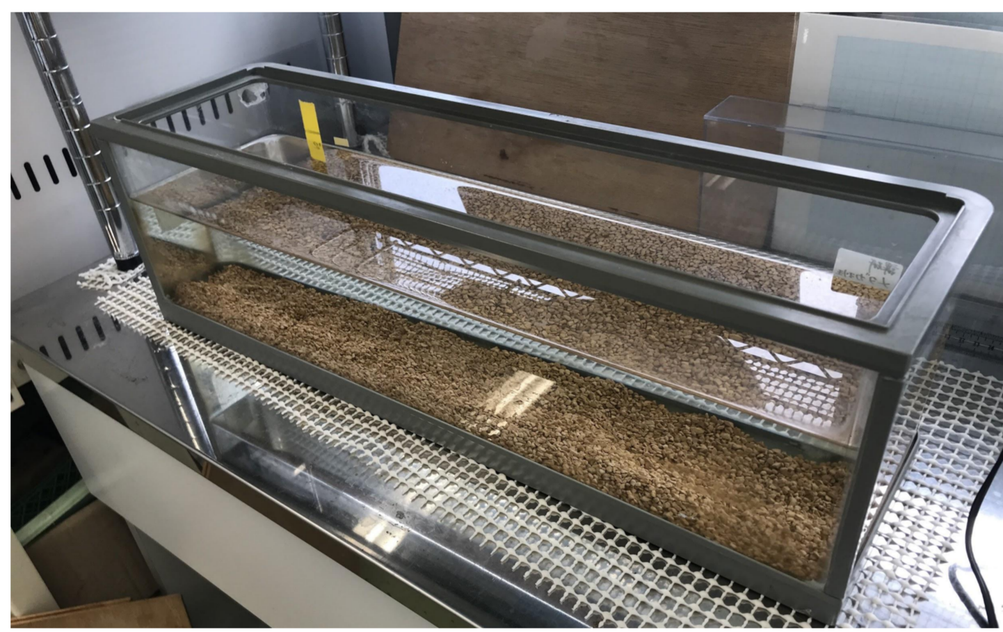
fig2.直方体の実験用水槽 (60cm × 18cm × 17cm)
