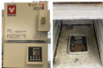
図3 電気炉での加熱処理の様子
