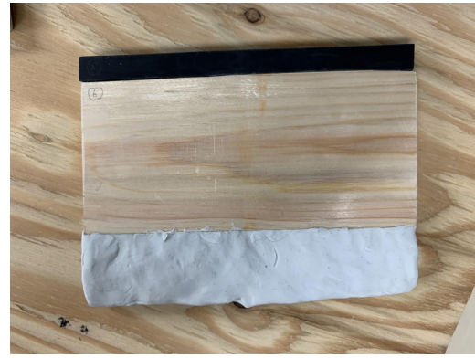
pic.2 ②落下面に厚さ1cmのゴムを付ける場合
