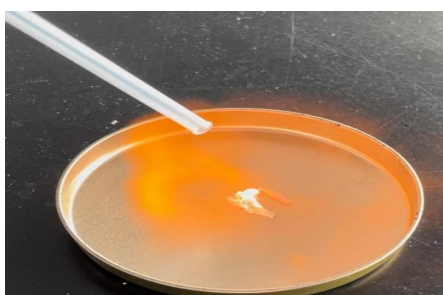
fig.1 白金箔に水素を噴射した際の反応
