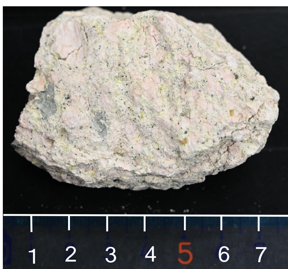
母岩(凝灰角礫岩)の岩片。凝灰質で溶融したような跡がある。
