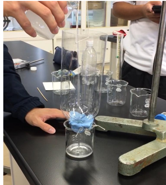
図3 実験に用いた簡易ろ過装置
