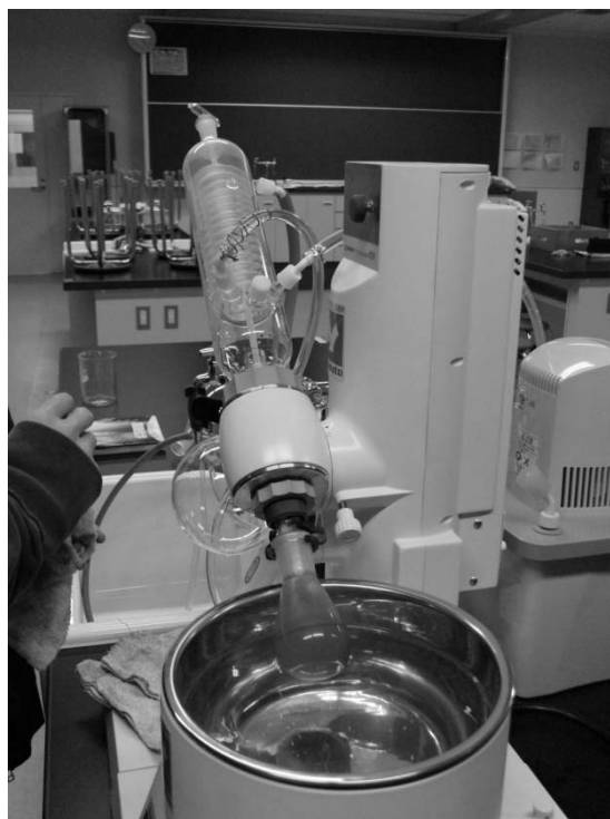
図 II：エバポレーターでの濃縮作業
