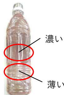
図2 銅めっきしたペットボトル
