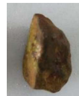
図4 銅めっきされたコンクリート
