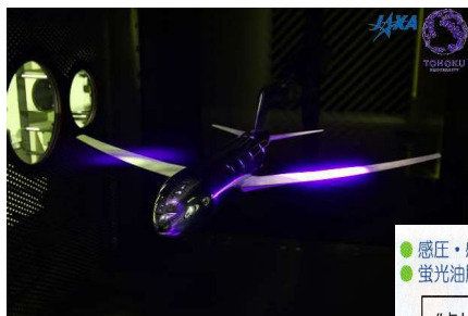
感圧塗料を使った風洞実験
