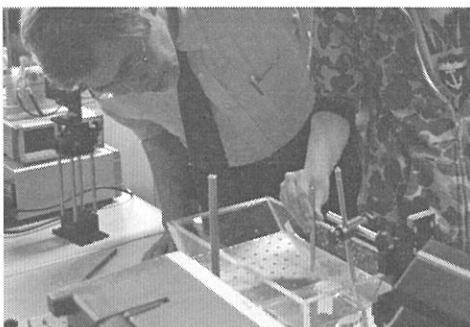
写真2 水を超音波によって振動させ、霧を発生させている様子
