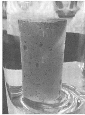
[fig.12]強度測定に使用したコンクリート柱
