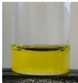
図2 水層からエーテル層に溶解した酸化金の様子
