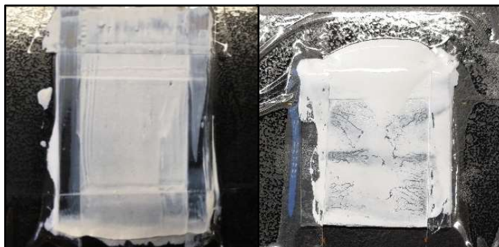
[図 6] TiO 2 サスペンション塗布後の導電性ガラス
