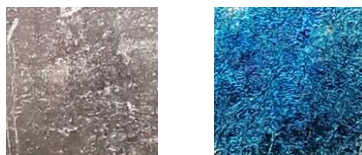
図4 加熱前(左)と加熱後(右)のめっき銅箔
