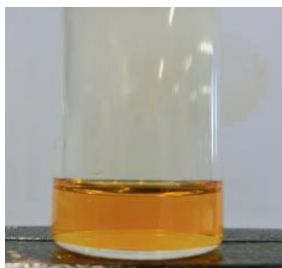
図 1 水層からエーテル層に溶解した酸化金の様子
