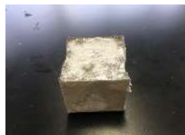
[fig.30] コ:ホ=4:1 表面にホウ砂が析出したコンクリート
