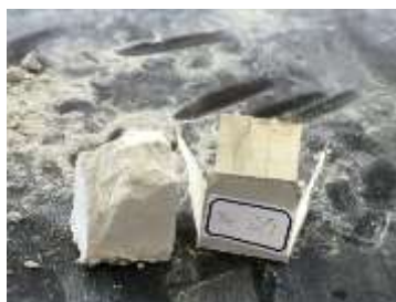
[fig.29] コ:ホ=10:1 中心部のみが固化したコンクリート
