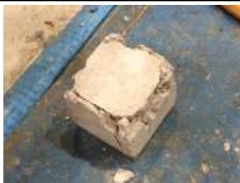
[fig.32]試験後の再固化コン
