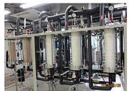
新規法によるバイオディーゼル連続製造装置 (イオン交換樹脂利用)
