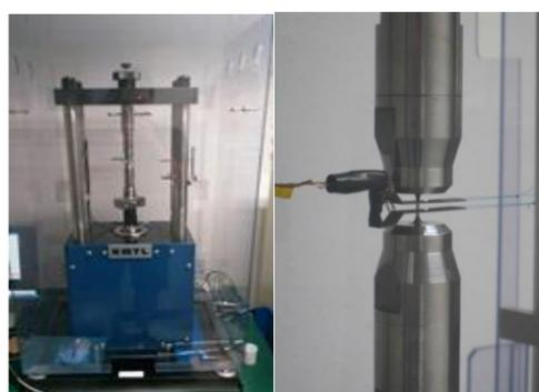
左) 疲労寿命を測るための機械
