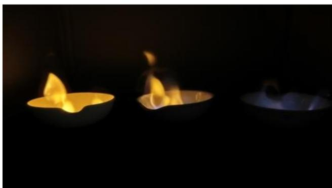
↑ 図 1 右から、塩化ナトリウムの飽和水溶液、飽和水溶液の二倍希釈、飽和水溶液の十倍希釈 (カーテンを閉め、段ボールの光除けの中で撮影した)
