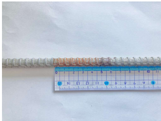
図5 腐食前後の鉄筋の様子
