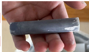
図1 3Dプリンターで作った型
